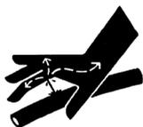
Não verifique vazamentos no circuito hidráulico com as mãos, a alta pressão pode provocar grave lesão.
